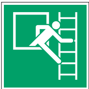
Fenêtre de secours avec échelle de secours (droite) E016B*
