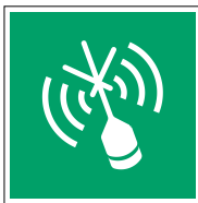
Radiobalise de localisation des sinistres E052
